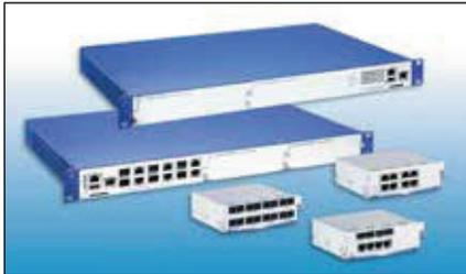
Die GREYHOUND 1040 Switches haben zwölf fest installierte Ports und zwei Slots für Medienmodule, mit denen Sie jeweils acht weitere Ports hinzufügen können, insgesamt also bis zu 28 pro Gerät.
