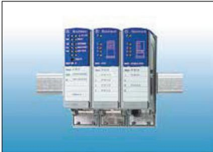
Die managed Ethernet-Switches der MS20-Serie verfügen über 8 bis 24 Ports mit max. 100 Mbit/s, vollständig überwacht und gesteuertes (Web, SNMP und CLI) IGMP Snooping (Multicast-Filter), VLAN, Port Mirroring, Port-Kontrolle, Port-Sicherheit, Link-Alarme, Broadcast Limiter, Verkehrsdiagnose, HIPER-Ring Redundanz, RSTP usw.
