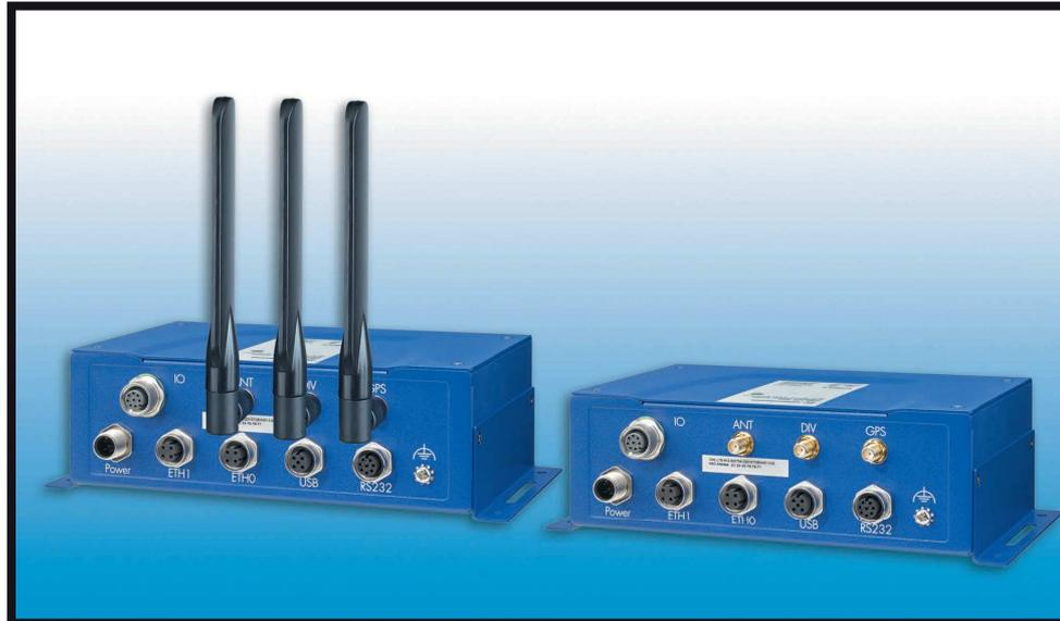
**Der OWL LTE M12 ist ein Mobilfunkrouter mit umfangreichen Funktionen, der sowohl drahtlose Verbindungen als auch Lösungen für den Internet- und Fernzugriff für Einsatzszenarien im Verkehrswesen bietet, in denen schnelle Mobilfunktechnologien und integrierte GPS-Funktionalität erforderlich sind.**
