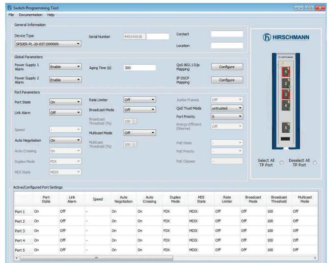
Das eigenständige Programmier-Tool der Switches, über das sich jeder Port individuell an die Anforderung der jeweiligen Anwendung anpassen lässt, läuft ohne Installation (auch von einem USB-Stick).
