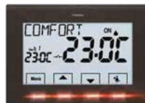
Über 21,1°C leuchten die Tasten rot, womit ein verhältnismäßig höherer Stromverbrauch angezeigt wird
