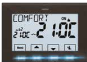
Zwischen 18,1°C und 21°C leuchten die Tasten blau, womit ein durchschnittlicher Stromverbrauch angezeigt wird
