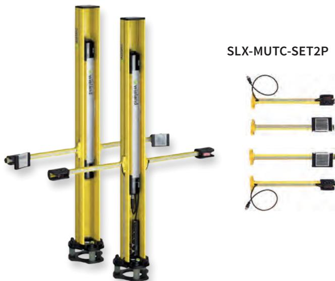
Das Muting-Set **SLX-MUTC-SET2P** wird für den Aufbau eines 2-Sensor-Parallel-Muting (Kreuz-Muting) benötigt, z.B. in Verbindung mit den separat zu bestellenden Gerätesäulen SLX-COL oder direkt an Sicherheits-Lichtgittern SLD.
