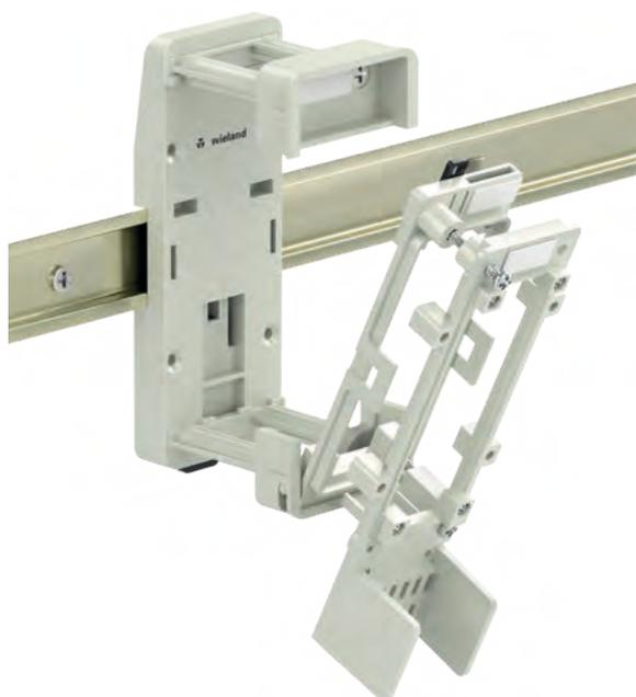
Die Halterahmen der revos BASIC Familie sind ideal einsetzbar in Niederspannungsschaltanlagen. Die Montage erfolgt direkt auf der Hutschiene 35 x 15 nach DIN EN 50022 im Schaltschrank. Eine Montage des Halterahmens auf einer 7,5 mm hohen Hutschiene 35 x 7,5 nach DIN EN 50022 ist nur möglich, wenn der Bauraum dahinter frei ist.
