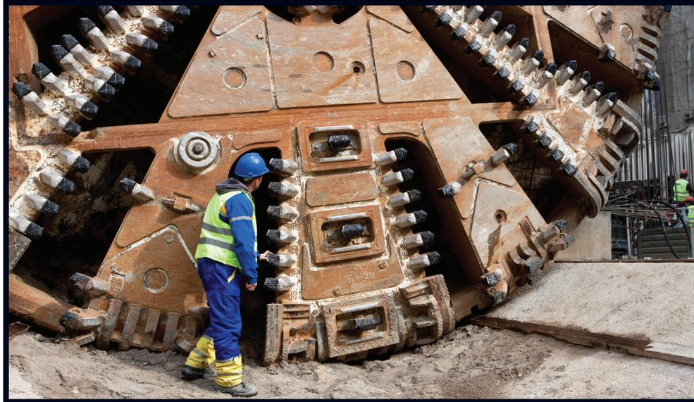
**1000 Tonnen schwere und 120 m lange Tunnelbohrmaschinen fräsen lasergesteuert Tunnelröhren mit einem Durchmesser von 8 m und montieren millimetergenau 6 Tonnen schwere Betonbauteile.**
